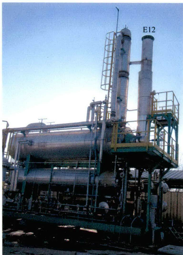
Fig. 2: Punto di emissione E12 rigeneratore glicol trietilenico
