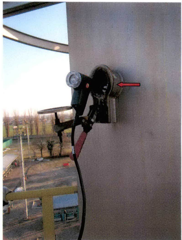
Fig. 5: Punto di prelievo dei fumi (freccia rossa)
