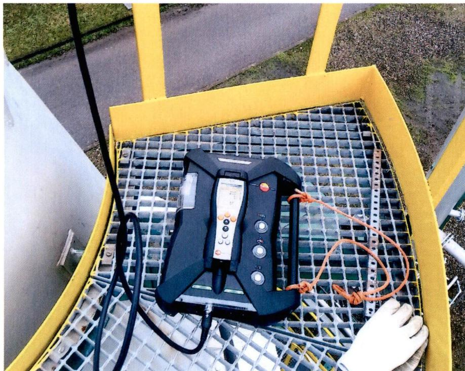
Fig. 1 - Analizzatore "Testo 350"
