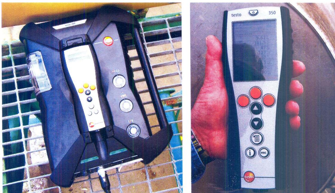
Foto 1: Testo 350 (unità di analisi e control unit)
