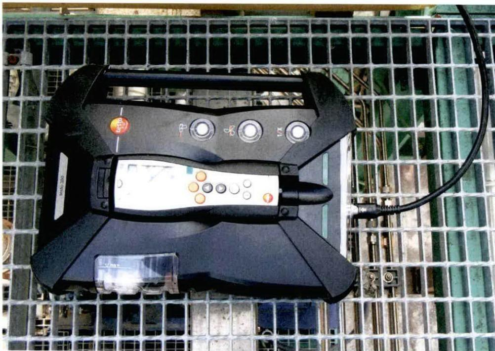
Fig. 1 - Analizzatore "Testo 350"
