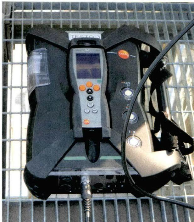
Foto 1 - Analizzatore "Testo 350"
