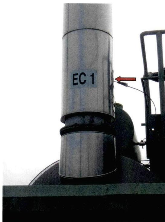
Foto 9 - punto di campionamento con sonda di prelievo
