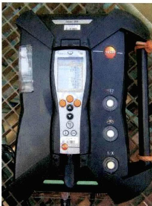
Fig. 1 - Analizzatore "Testo 350"
