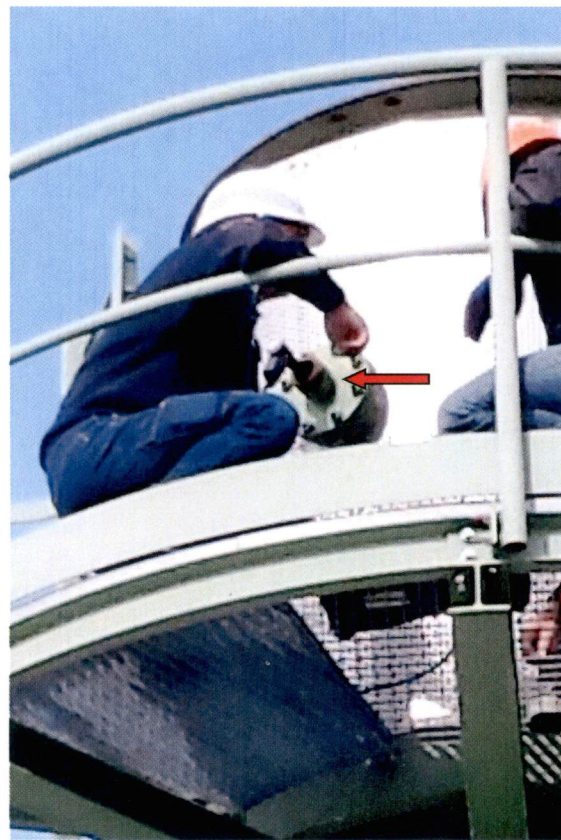
Fig. 5: Punto di prelievo dei fumi (freccia rossa)
